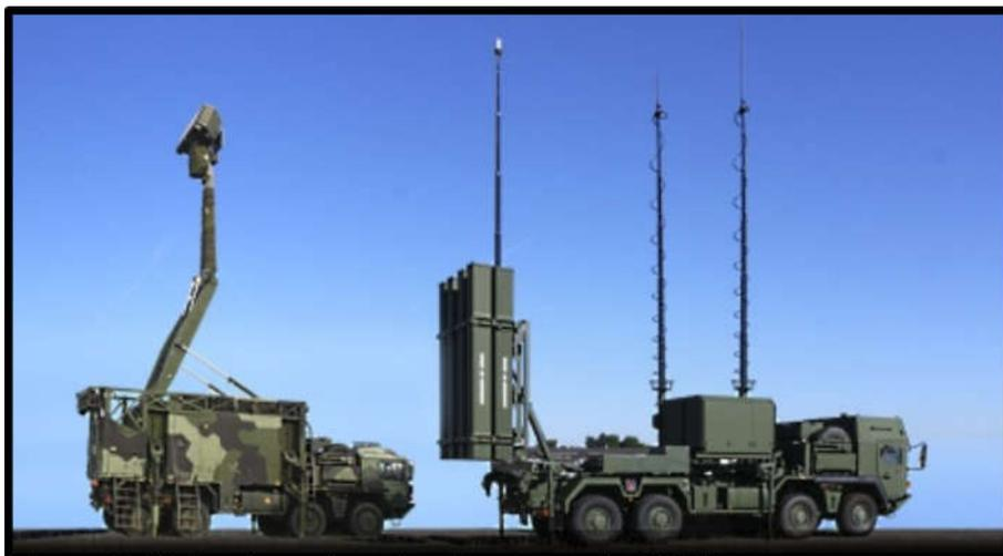
Figura 1: Viatura lançadora de mísseis e radar M200
