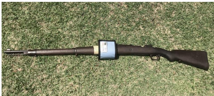
FIGURA 5 - FOTO DO FUZIL MAUSER COM CANELEIRAS DE PESO SIMULANDO O FUZIL 7,62 (ESCLARECEDOR)
