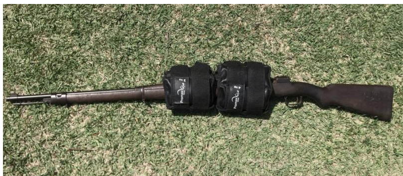
FIGURA 6 - FOTO DO FUZIL MAUSER COM CANELEIRAS DE PESO SIMULANDO A METRALHADORA MAG (ATIRADOR DA MAG)
