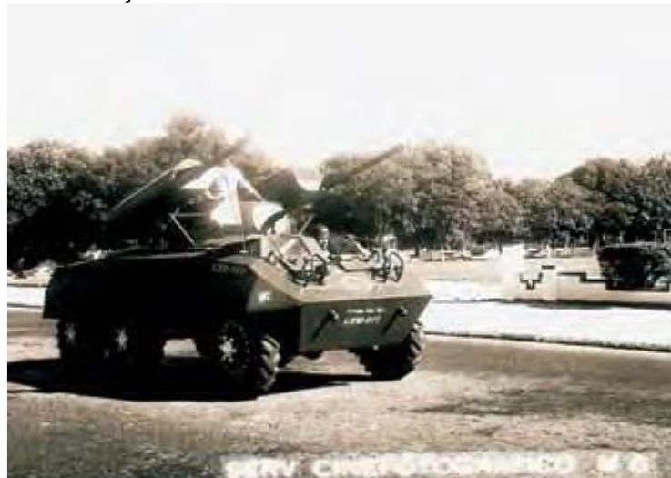
Lançador de foguetes rotativo acoplado à torre de um M-8 Greyhound 6x6, desenvolvida pelo IME, desfilando em 28 de junho de 1966.
