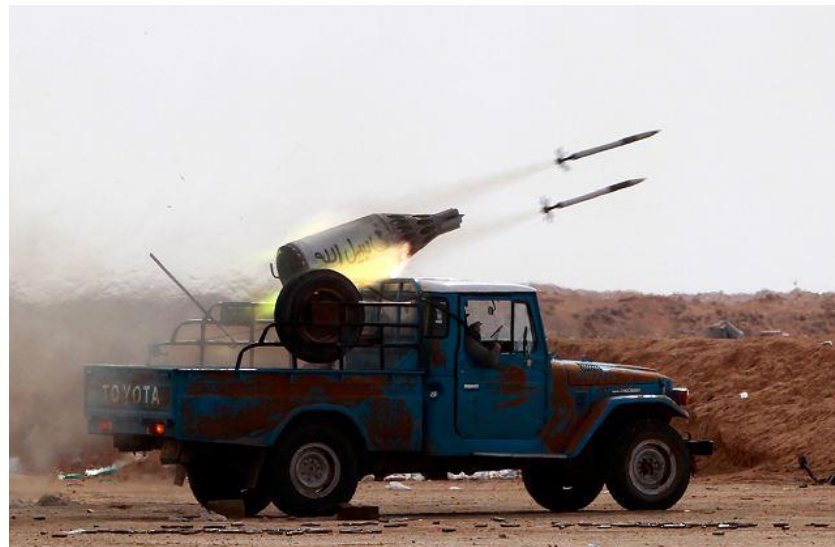
Figura 16: Rebelde na Líbia empregando lançador de foguetes capturado de helicóptero inimigo e adaptado sobre pick up civil
