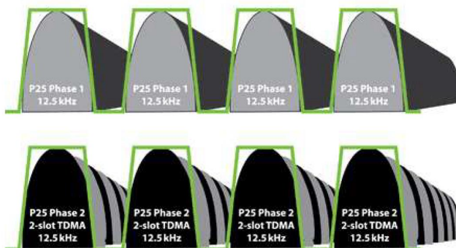
Figura 2: Comparação Fase 1 (FDMA) e Fase 2 (TDMA) Fonte: TAIT COMMUNICATIONS, 2015.
