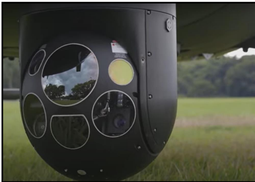
Fig 6-10 – Câmera instalada em vetor aéreo para um sistema de imageamento
