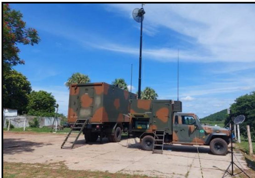
Fig 6-1 – Viatura operacional estruturada para conexão entre sistemas de comunicações
