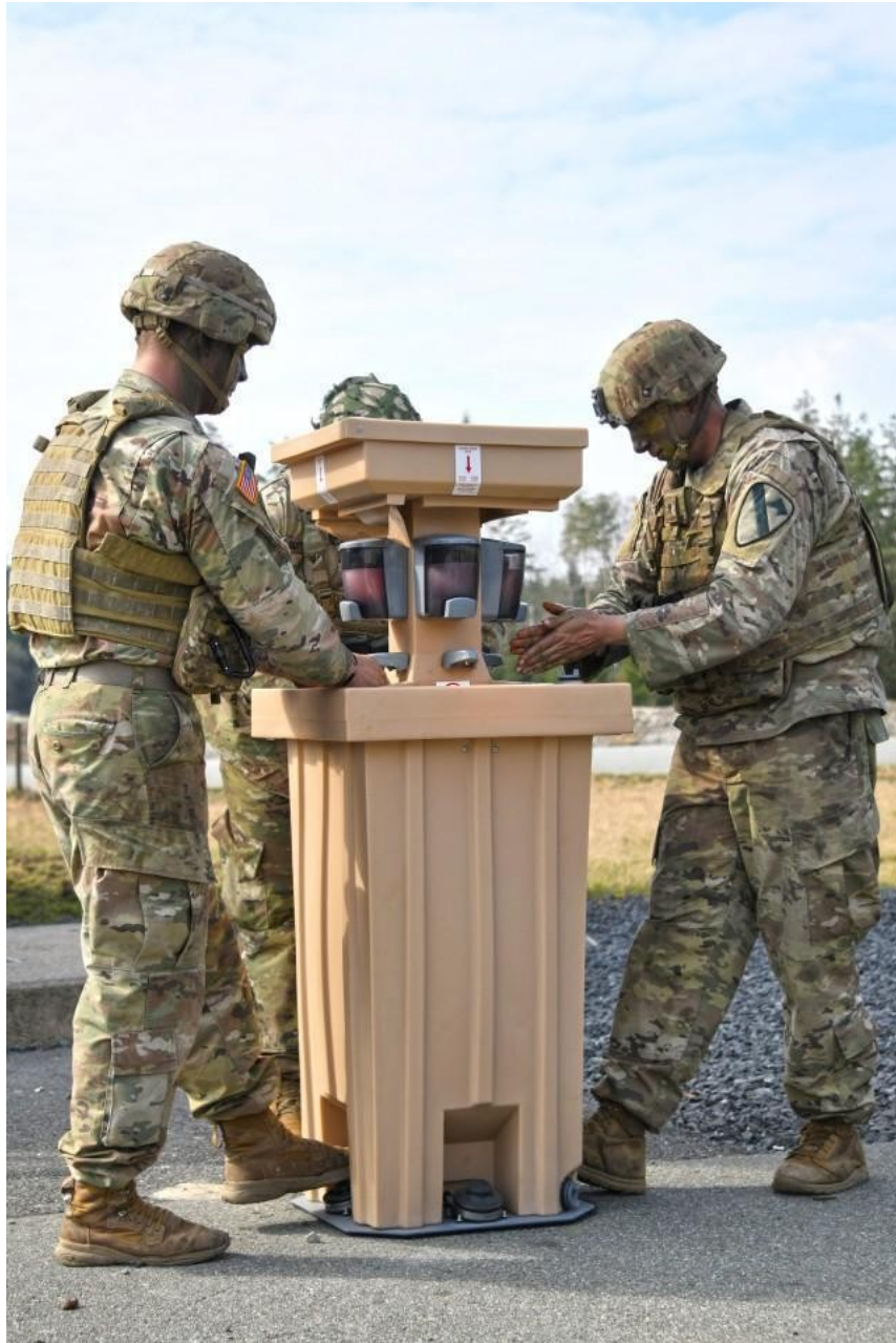
Figura 4: Estação de lavagem de mãos utilizada pelo Exército americano. Equipamento modular que pode ser facilmente transportado e desdobrado no terreno durante treinamentos e operações à campo, ou mesmo ser utilizado em locais estratégicos dos quartelamentos, c campo, ou mesmo ser utilizado em locais estratégicos dos quartelamentos, como próximo a refeitórios e banheiros. Fonte: Stevens (2020).
