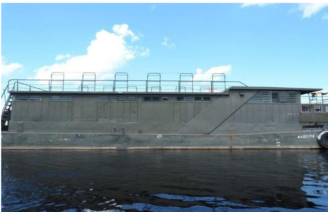
FIGURA 6 - Exemplo de balsa com superestrutura Fonte: DAMEPLAN (2018).
