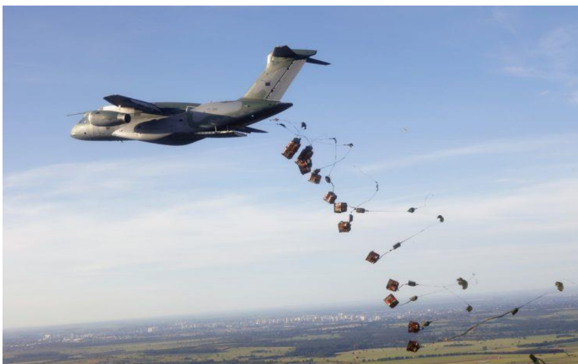
Figura 1. Lançamento múltiplo de cargas médias tipo CDS do KC-390
