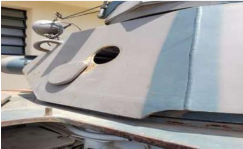
Figura 18 – Espessura da chapa bimetálica Fonte: Dias, 2022.
