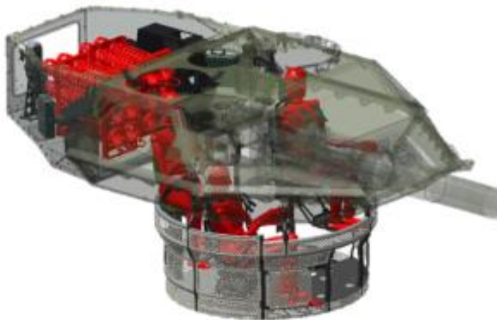
Figura 29 – Disposição da guarnição no interior da torre Fonte: CIO, 2020.
