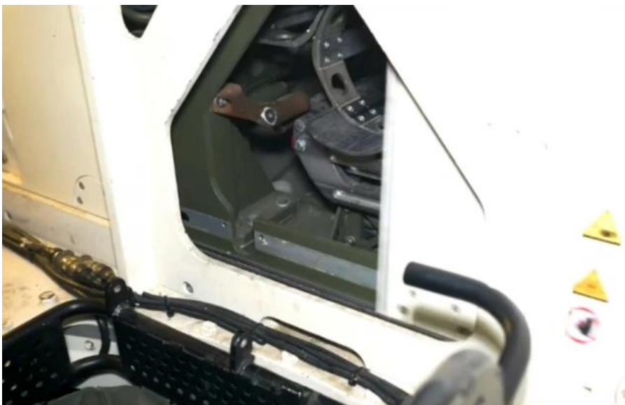
Figura 30 – Porta corta fogo blindada que separa o compartimento da munição dos tripulantes na torre Fonte: CAIAFA, 2022.
