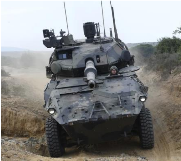
Figura 27 – Centauro II com sua torre HITFACT Mk II Fonte: CAIAFA, 2022.
