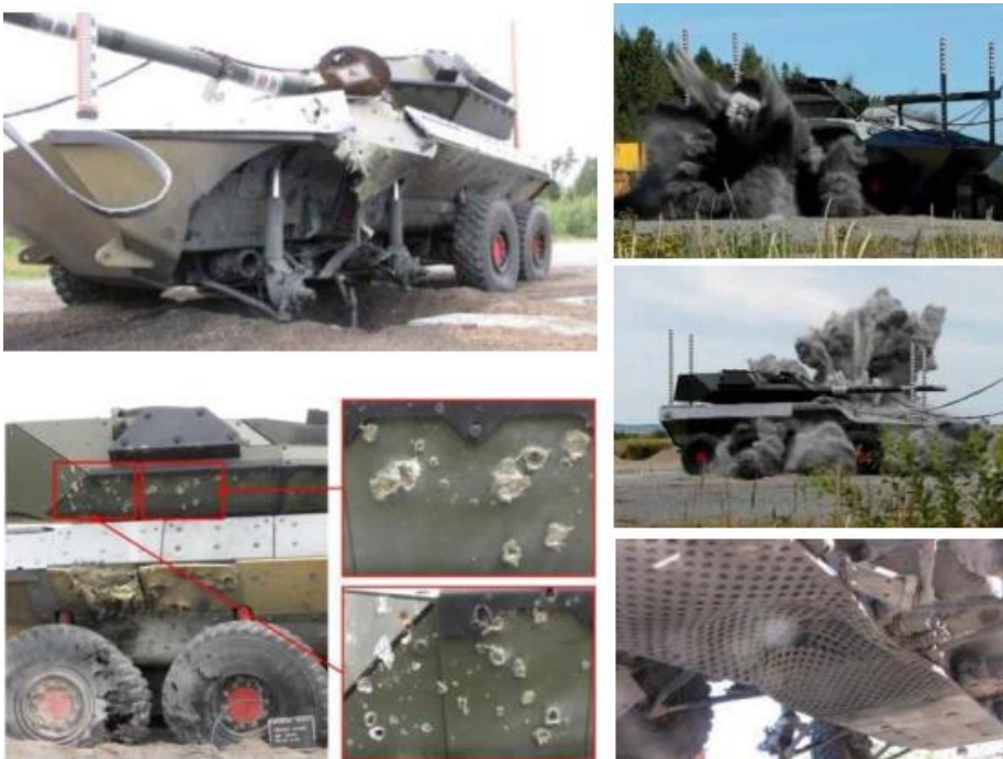
Figura 35 – Teste de sobrevivência de acordo com a AEP-55 STANAG 4569 Fonte: CIO, 2020.
