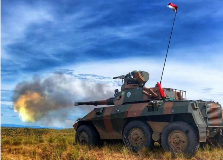
Figura 16 – O EE-9 com canhão nacional EC-90 de 90 mm Fonte: ANNES e MATOZO JR., 2022.
