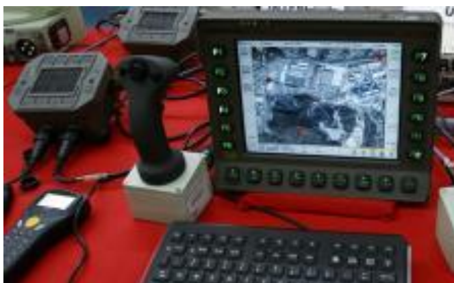
Figura 18 – Sistema SICCONA da VBC CAV MSR 8x8 CENTAURO II.
