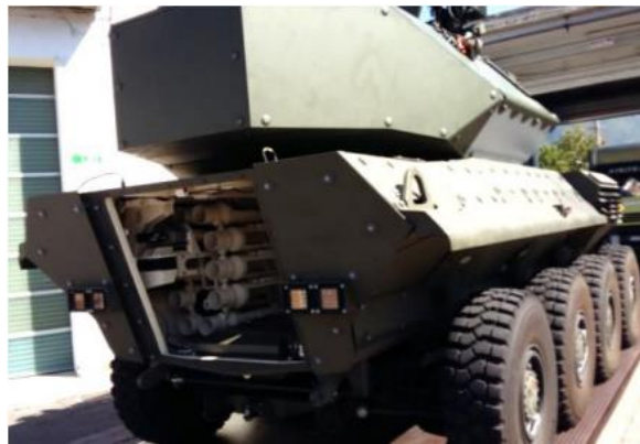
Figura 17 – VBC CENTAURO II com compartimento da munição amostra. Fonte: Palestra CIO ao EB (2020).
