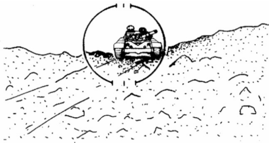
Ilust. 5-3. Estimación de la Distancia Mediante el Diámetro del Retículo
