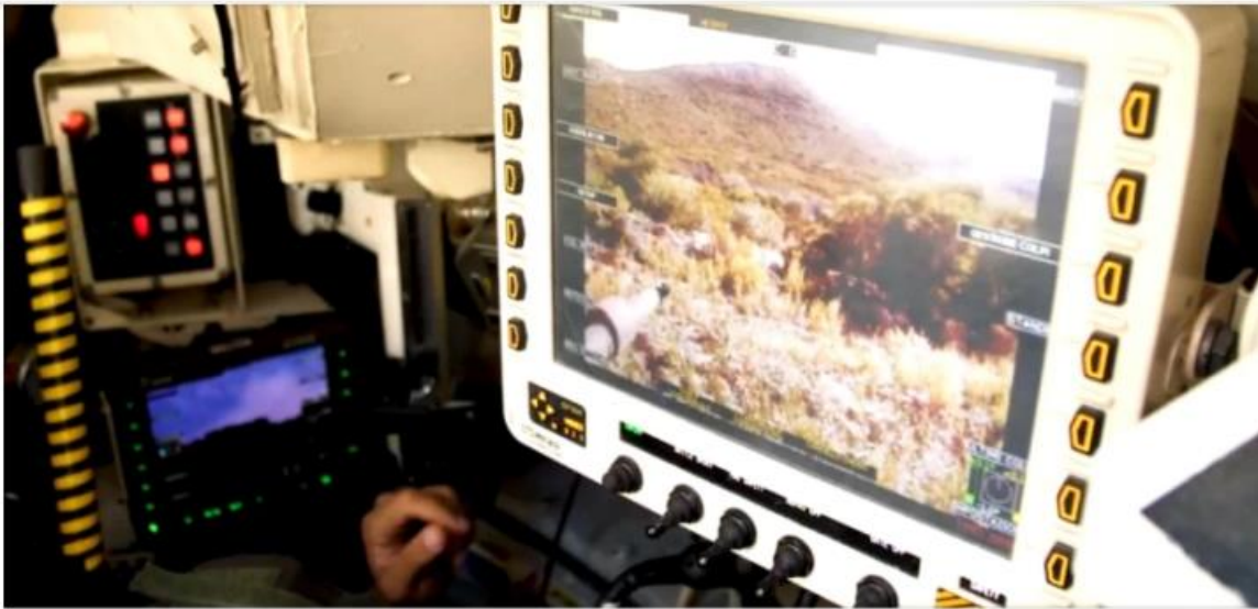
FIGURA 14 – Sistemas de tiro e observação do Comandante e Atirador da VBC Cav Centauro II Fonte: Disponível em < https://www.infodefensa.com/texto-diario/mostrar/3811626/spezia-e-brasil-canhes-navais-munices-quiadas-e-blindado-8x8-centauro-ii >. Acesso em: 19 out. 2023.
