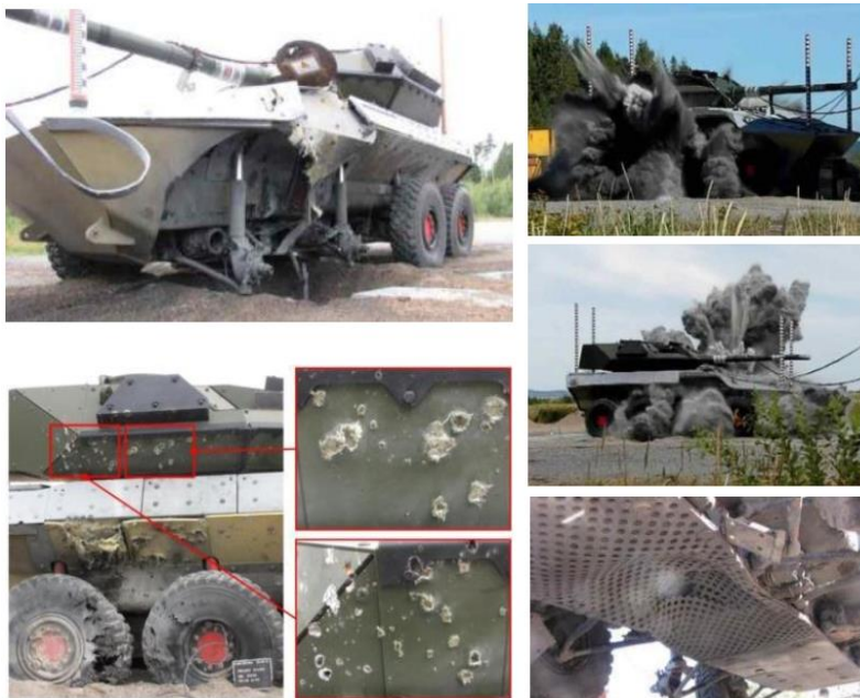
FIGURA 12 – Testes de verificação de blindagem da VBC Cav Centauro II Fonte: Apresentação do CIO ao Exército Brasileiro (2020)
