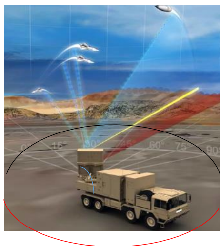
Figura 7 – Setor de observação do radar
