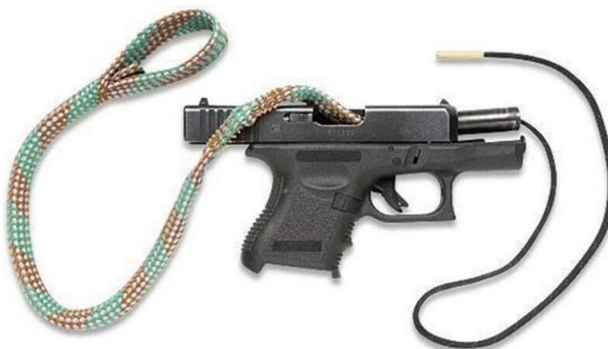
Figura 6 – Demonstração do sentido de limpeza utilizando Boresnake .
