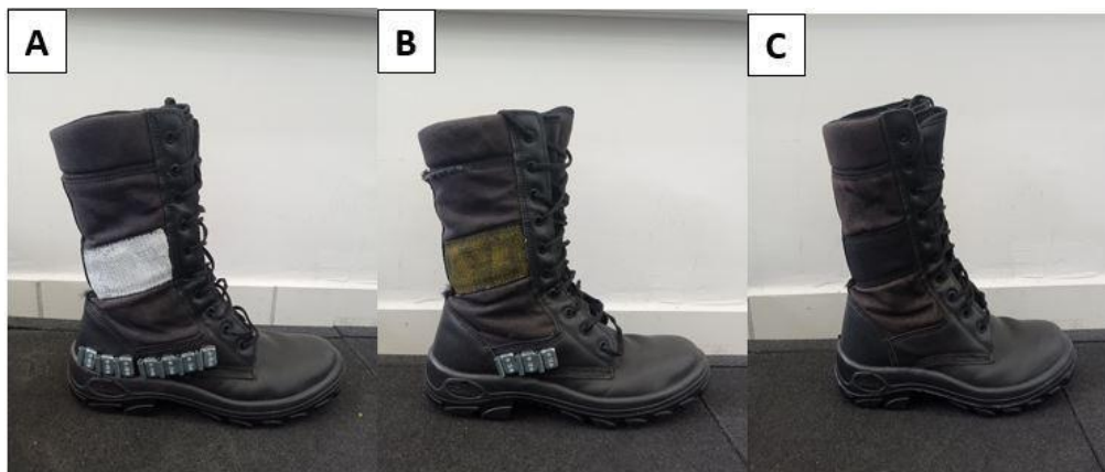
Figura 1 – Coturno com solado sem fibra de carbono (A), com fibra de carbono (B) e coturno com solado de SBR (C). Os pesos fixados na lateral do calçado serviram para igualar a massa dos calçados.
