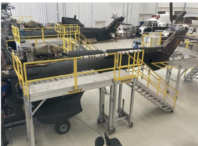
Figura 7 – Plataformas para trabalho em altura
