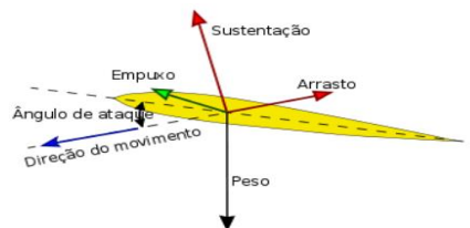
Figura 1 – Sustentação do perfil de uma pá.
