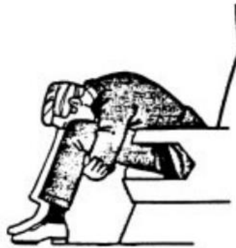
Figura 2. Posição brace utilizada em aeronaves de asa fixa
