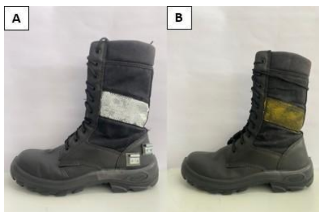
Figura 2 – Coturno com solado sem fibra de carbono (PUSP) (A) e com fibra de carbono (PUCP) (B)
