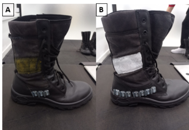
Figura 2 – Coturno com a placa de carbono na entressola (PUCP) (A) e coturno sem a placa de carbono (PUSP) (B).
