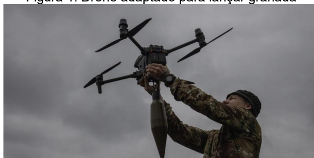
Figura 1: Drone adaptado para lançar granada
