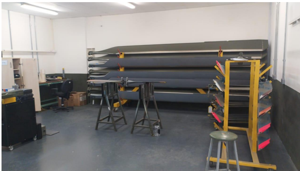
Figura 6 – Pás RP e RC da aeronave HA-1 Fennec mantidas Fonte: O autor, 2023
