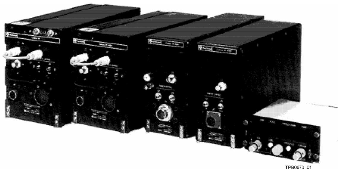
FIGURA 11 - Componentes do Sistema de Rádio HF-9000 presente nas aeronaves HM-1 e HM-4 Fonte: Collins (2004, p. IX)
