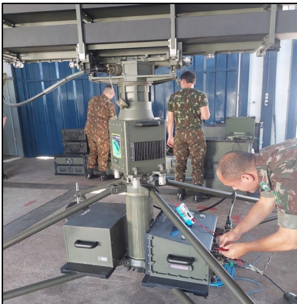
Figura 15 – Manutenção do Radar SABER M60 no 3º GAAe Fonte: Seção de Comunicação Social do 3º GAAe
