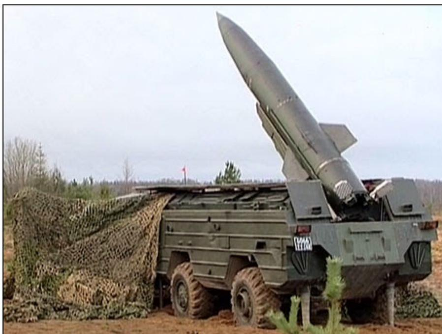
**FIGURA 10** – Míssil Tochka-U em sua plataforma de lançamento.
