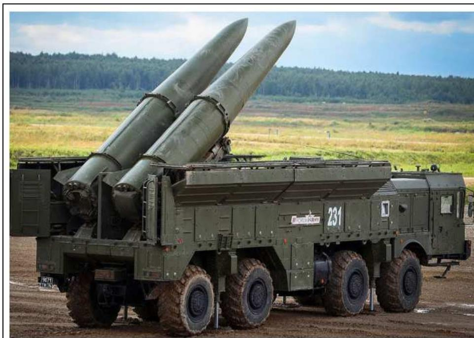
**FIGURA 9** – Míssil 9K720 Iskander em sua plataforma de lançamento.
