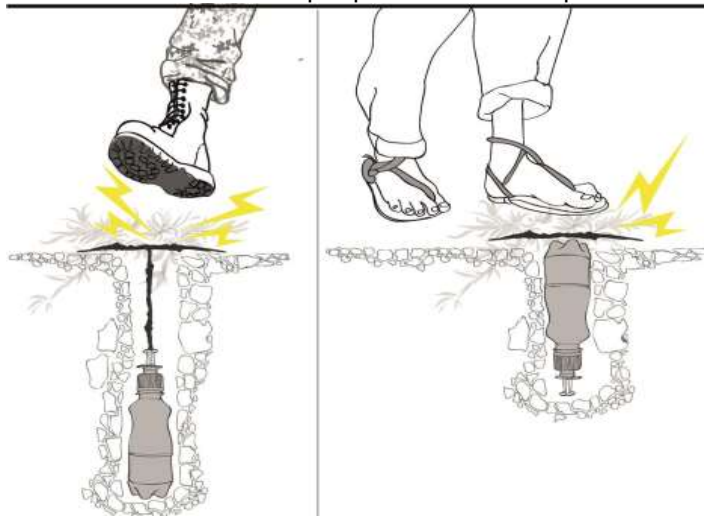
FIGURA 4: acionamento por pressão-alívio de pressão
