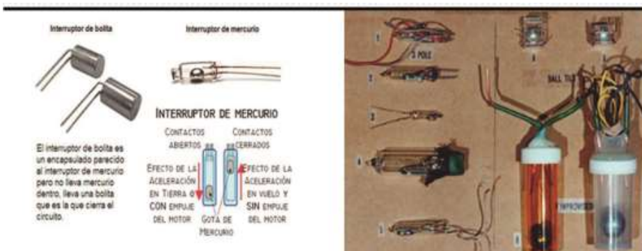
FIGURA 6: acionamento de sensor de movimento
