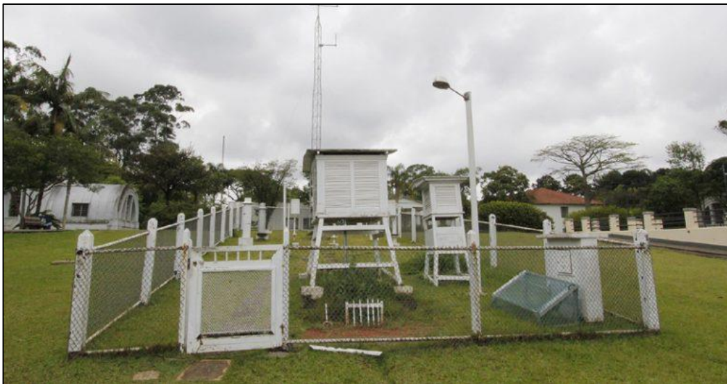
Figura 13 - Estação Meteorológica Convencional
