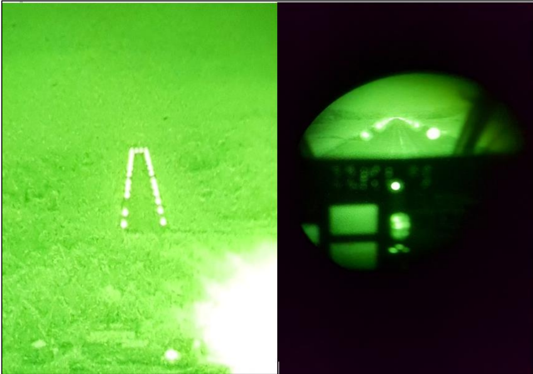
Figura 11 - Pista de pouso iluminada com o Sistema SAWL
