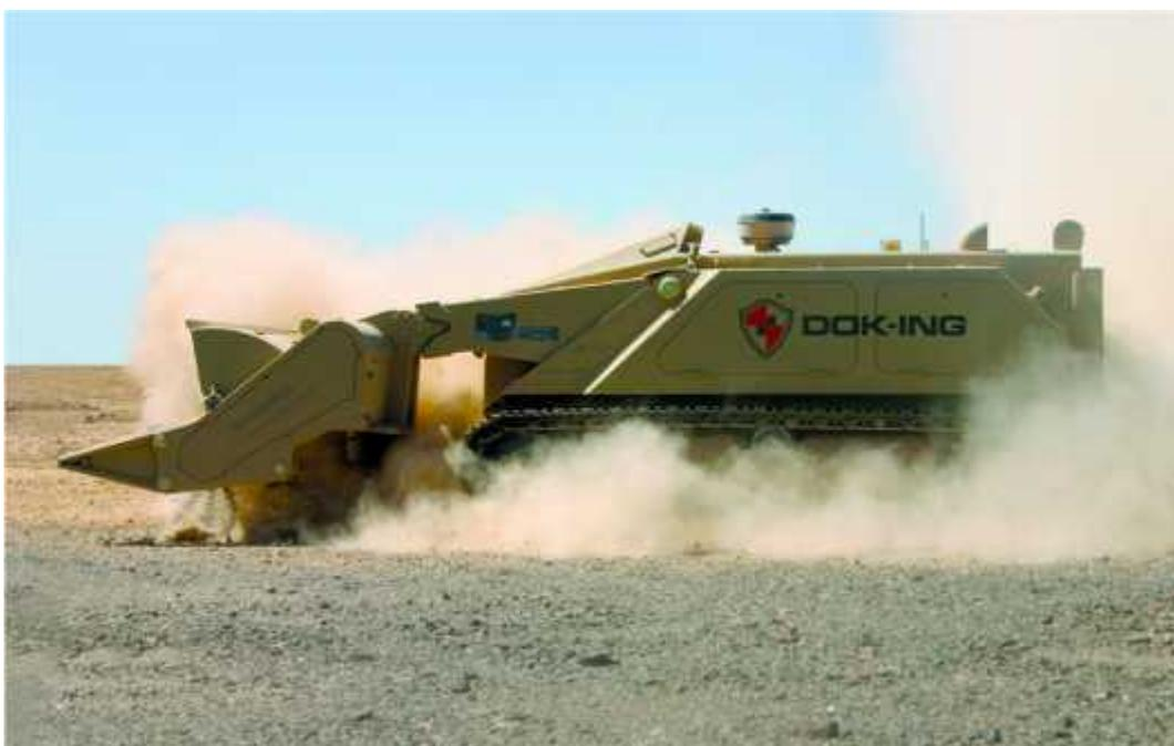
Figura 4 – Sistema robótico DOK-ING MV-4
