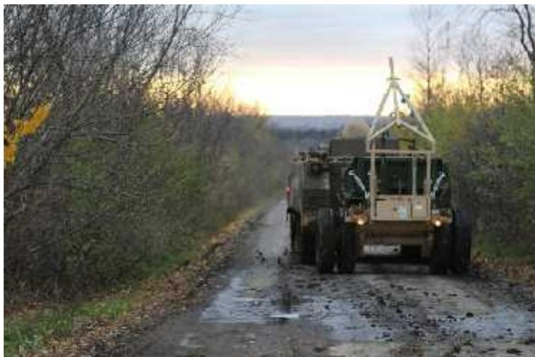
Figura 1 – Equipamento de abertura de brechas modelo M58 MICLIC
