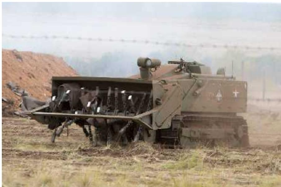
Figura 6 – Sistema robótico de limpeza de minas URAN-6
