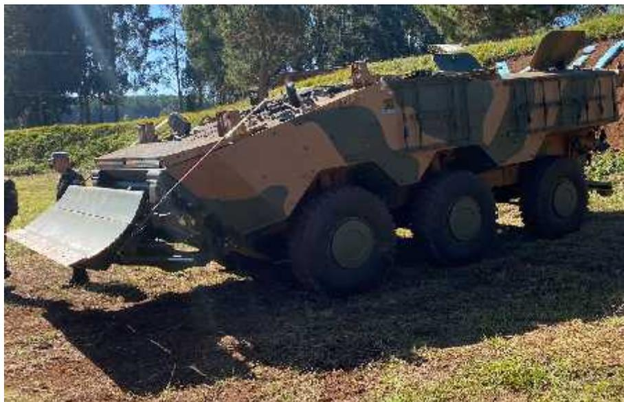
Figura 13 – VBE Eng com lâmina para remoção de obstáculos
