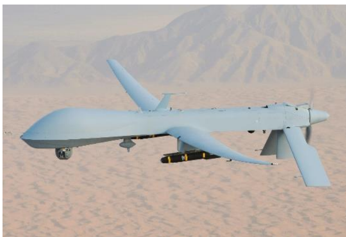
FIGURA – 11: ARP Predator armado com míssil Hellfire .
