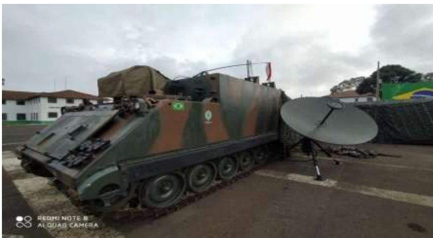
Figura 4.2.1 – O terminal SISCOMIS e o C Com embarcado
