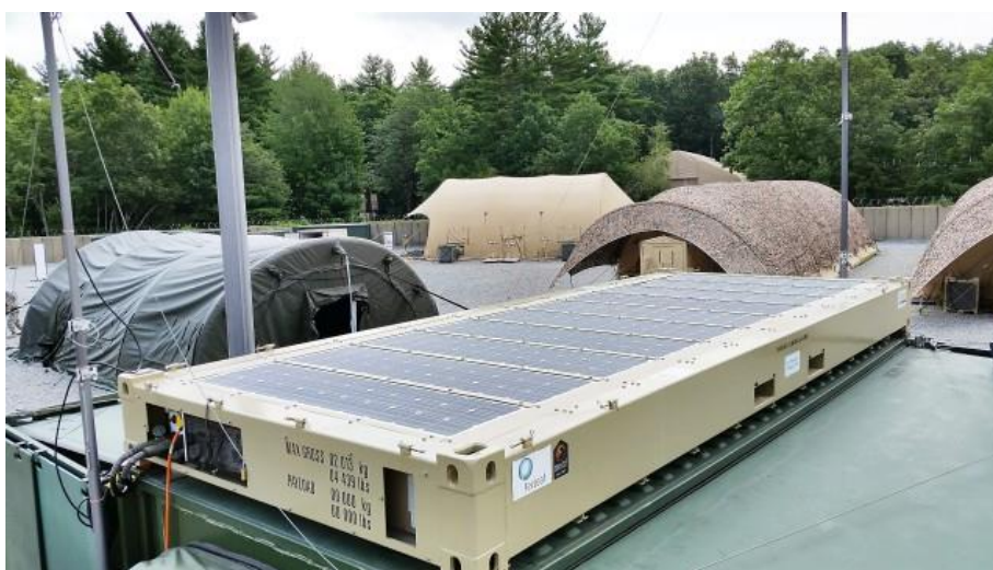
Figura 7: Sistema de gerador fotovoltaico adquirido pelo Exército e Marinha dos Estados Unidos Fonte: LAFONTAINE, 2016
