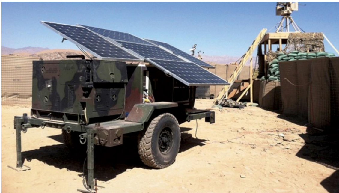
Figura 6: Sistema móvel de gerador de energia solar Fonte: SIMPLIPHI POWER, 2015
