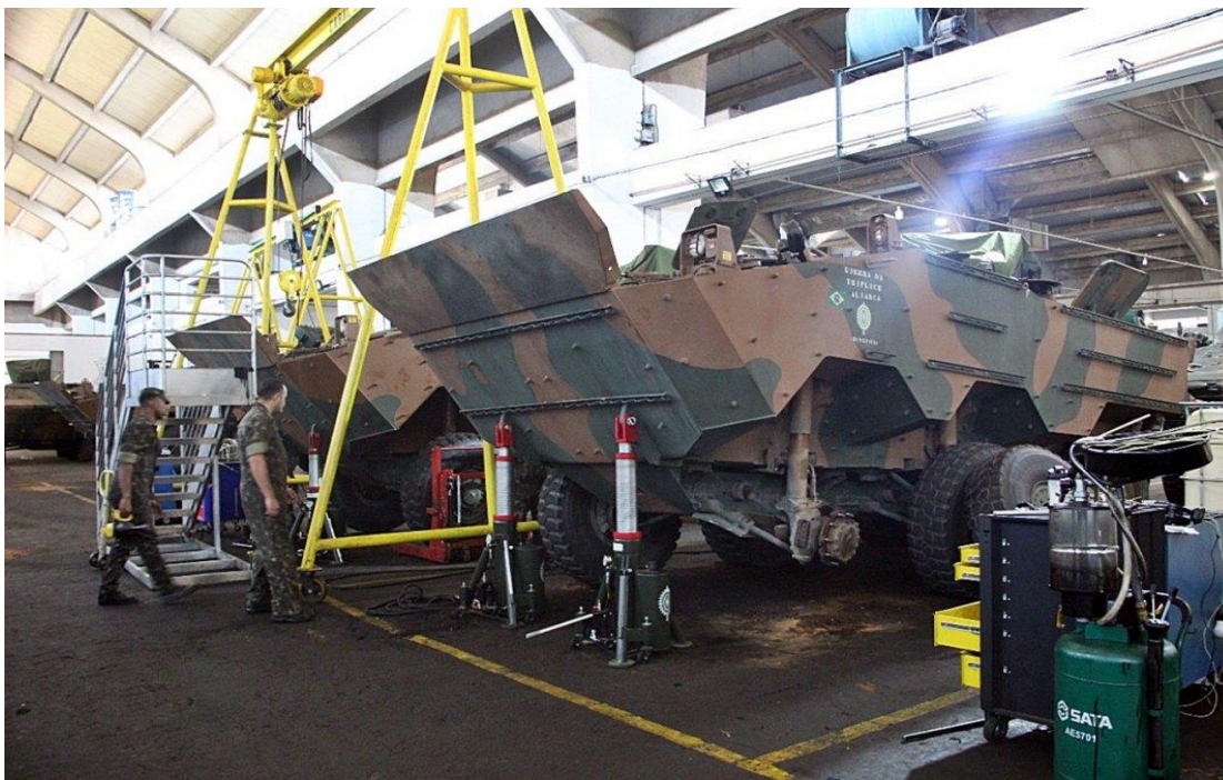
FIGURA 6- Manutenção em 1º escalão da VBTP Guarani Fonte: Fan (2022).
