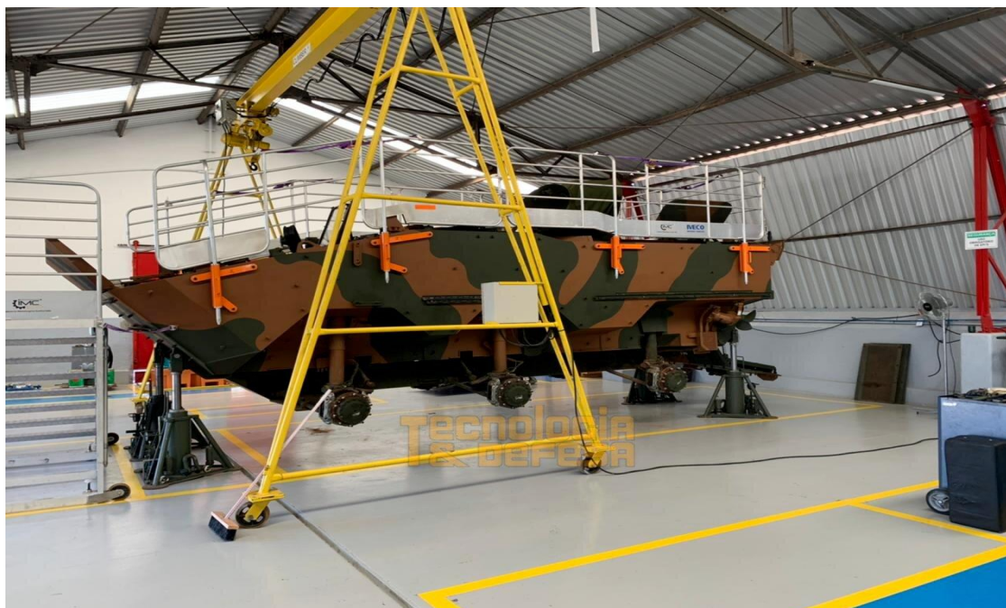
FIGURA 9 – Exemplo de estrutura de garagem e ferramental adequados para a manutenção de VBTP Guarani.
