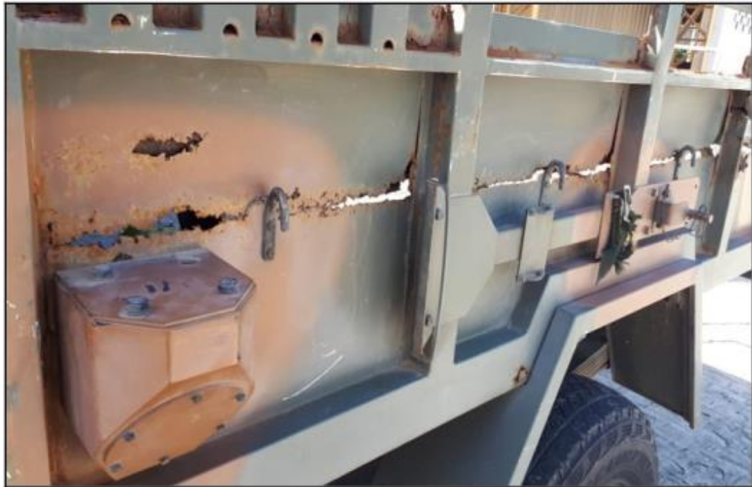
Figura 01 – Desgaste com corrosão excessiva das viaturas Agrale Marruá Fonte: BARROS, 2021
