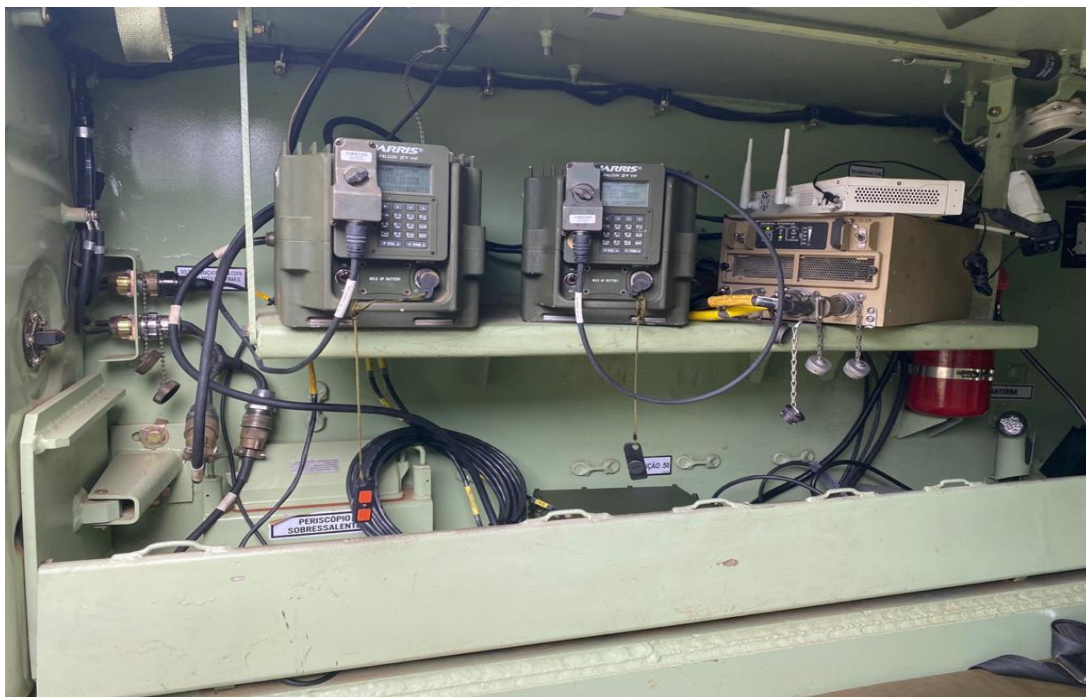
4- Rádios RF-7800V-V560, Inversor e Switch Vtr M113 BR
