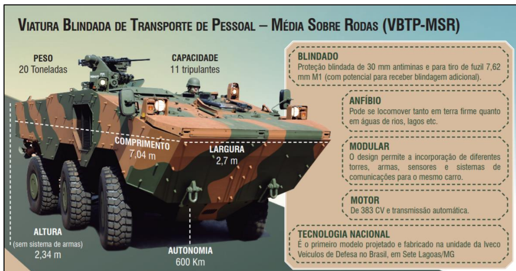
Figura 2 – Viatura Blindada de Transporte de Pessoal – Média Sobre Rodas (VBTP-MSR 6x6) Guarani Fonte: EPEX
