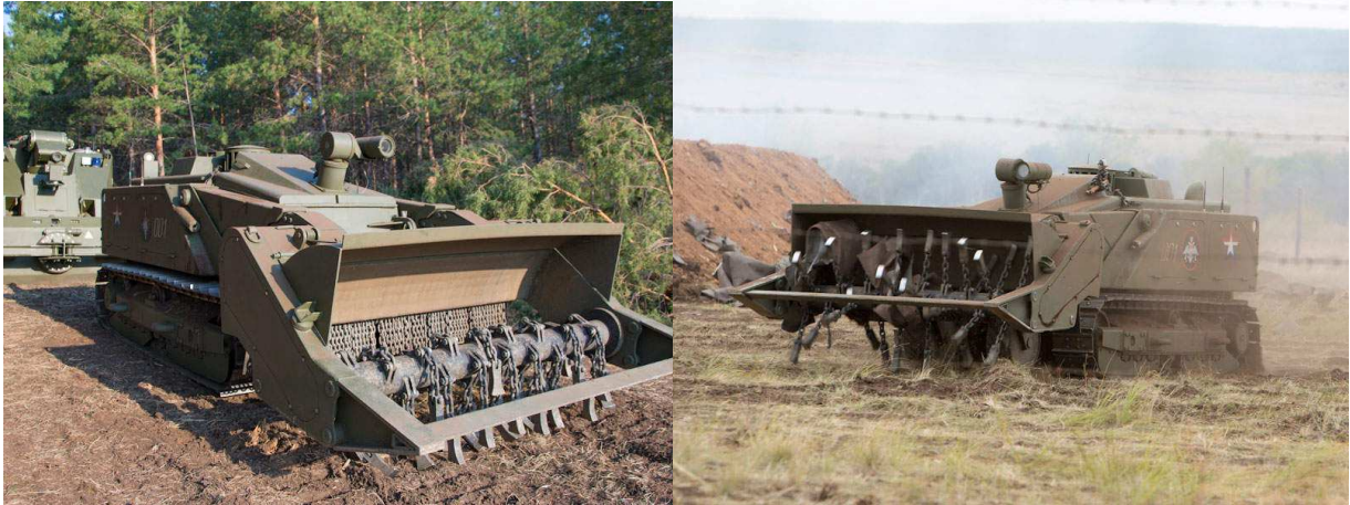
Foto 8 e 9 – Veículo de desminagem URAN-6. Fonte: https://www.army-technology.com/projects/uran-6-mine-clearing-robot/#catfish . Acesso em 12 abril de 2023
