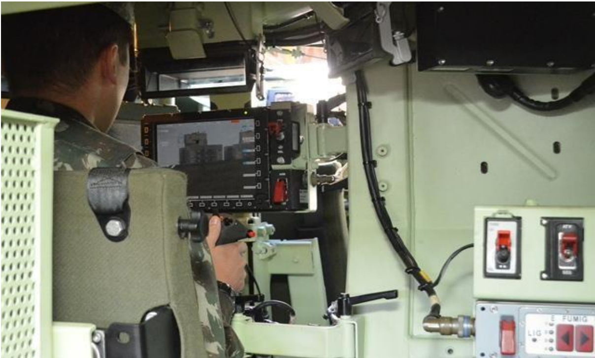
Figura 6 – Sistema de controle da torre UT-30BR
