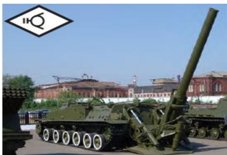
Figura 14 - "Morteiro" 2S4 Tyulpan de 204 mm Fonte: KANSAS, 2016
