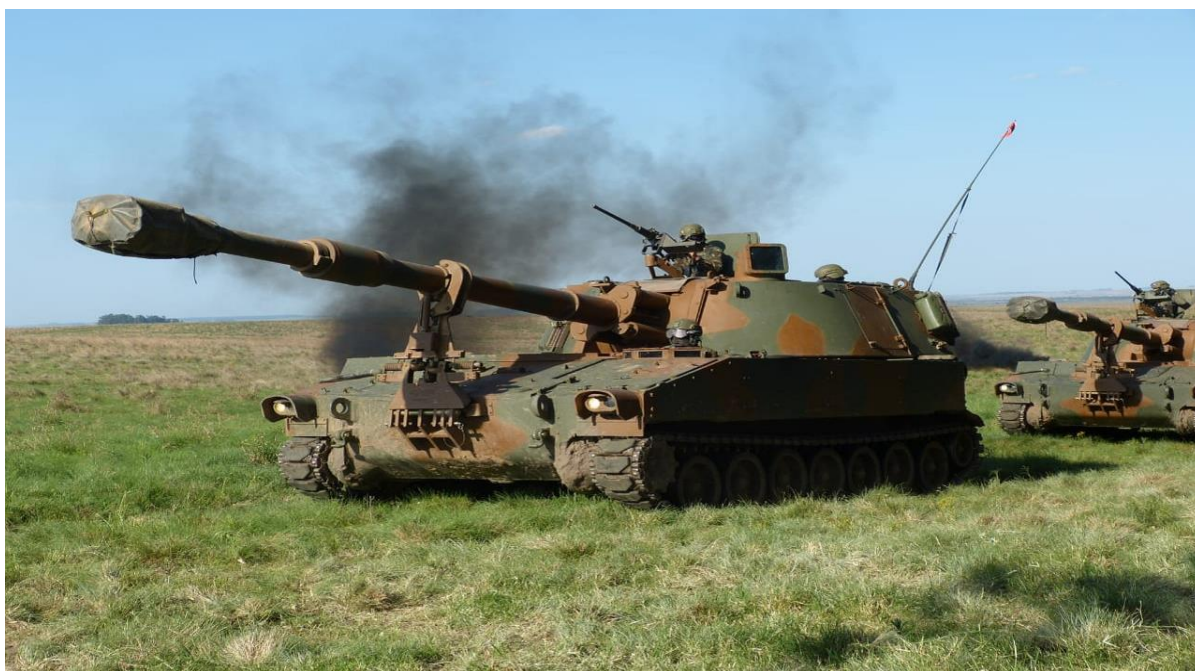
Figura 2 - VBC OAP M109 A5 +BR do 3º GAC AP (possuidor de sistema digital de tiro – navegação inercial e GPS) em adestramento no Campo de Instrução Barão de São Borja Fonte: o Autor
