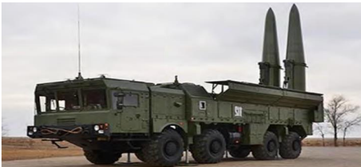
Figura 7 - Lançadora russa 9K720 Iskander, míssil balístico (alcance de 500 Km) Fonte: KANSAS, 2016
