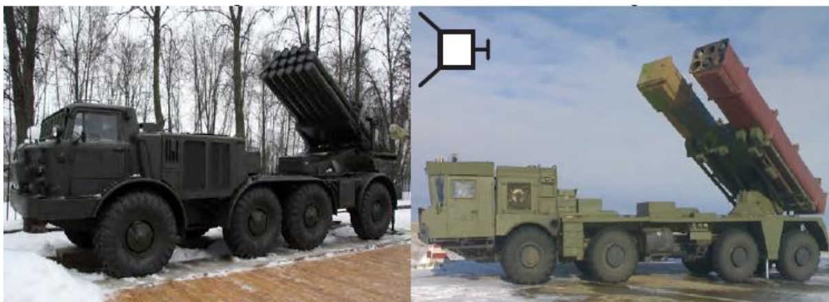
Figura 10 - Lançadoras russas BM-27 Uragan e 9A53 Uragan de 220 mm MLRS Fonte: KANSAS, 2016
