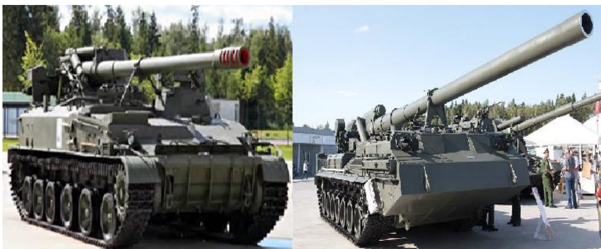
Figura 13 - Obuseiros Autopropulsado 2S5 Giatsint-S de 152 mm e 2S7 Pion/Malka de 203 mm Fonte: KANSAS, 2016
