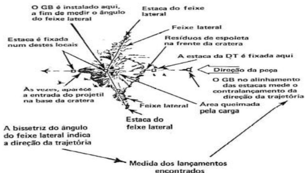
Fig 5-8 Determinação da direção da arma inimiga, pela utilização do feixe lateral de estilhaços.
