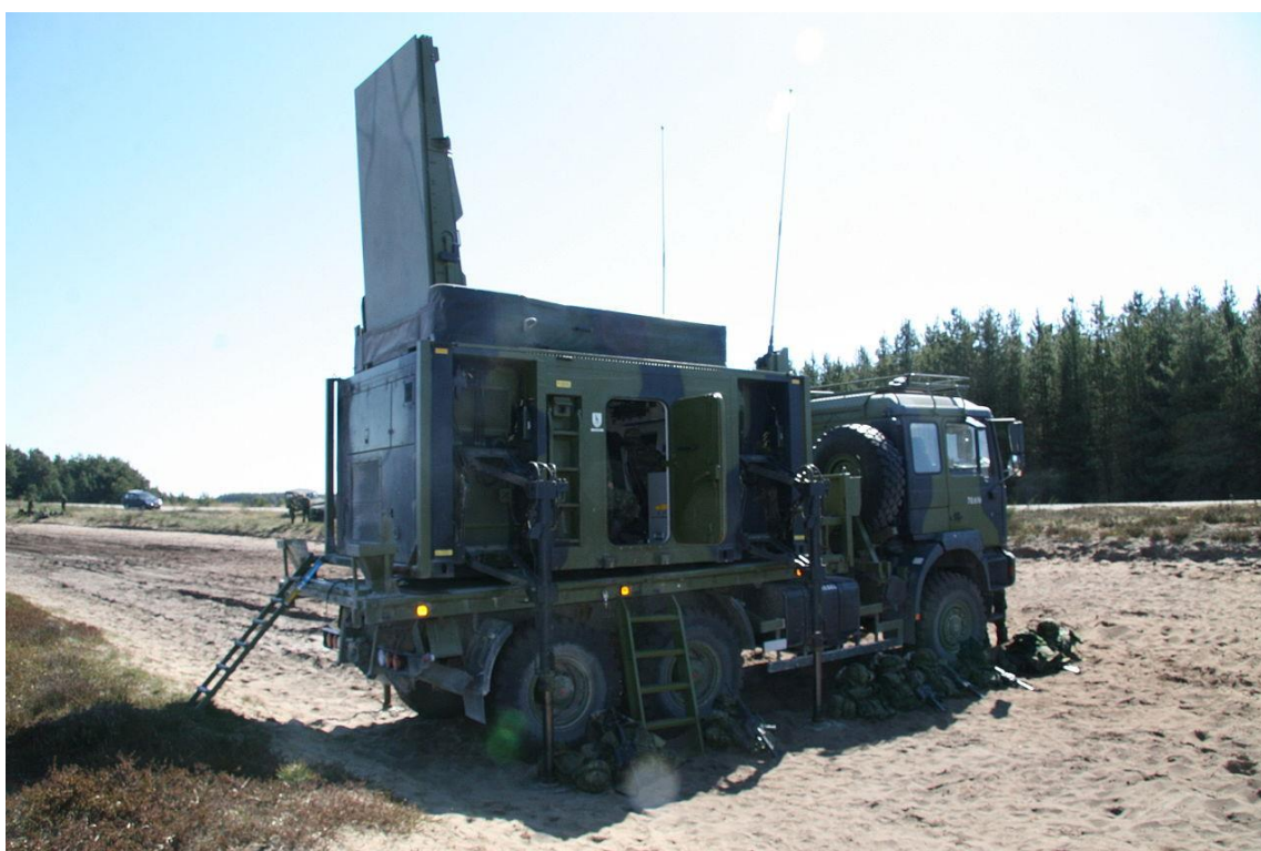
Figura 9: Radar ARTHUR em operação Fonte: stringfixer.com
