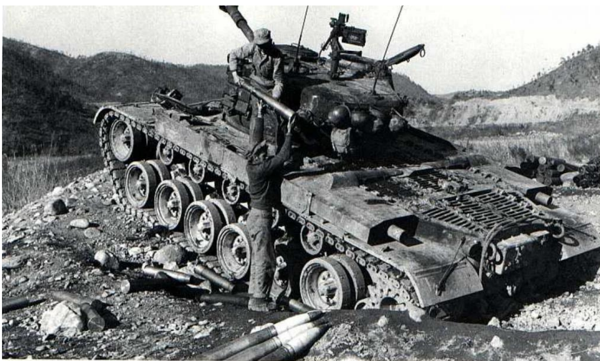
Figura 3: Blindado M46 da 1ª Divisão dos Marines sendo utilizado como artilharia em 23 de novembro de 1951. O blindado foi posicionado em uma rampa para obter um ângulo superior a 20 graus (320’’).
