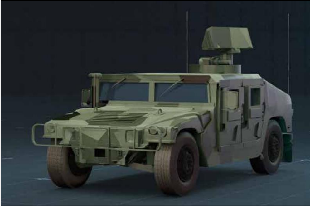
Figura 16: Giraffe 1x em uma viatura 4x4 sobre rodas Fonte: SAAB
