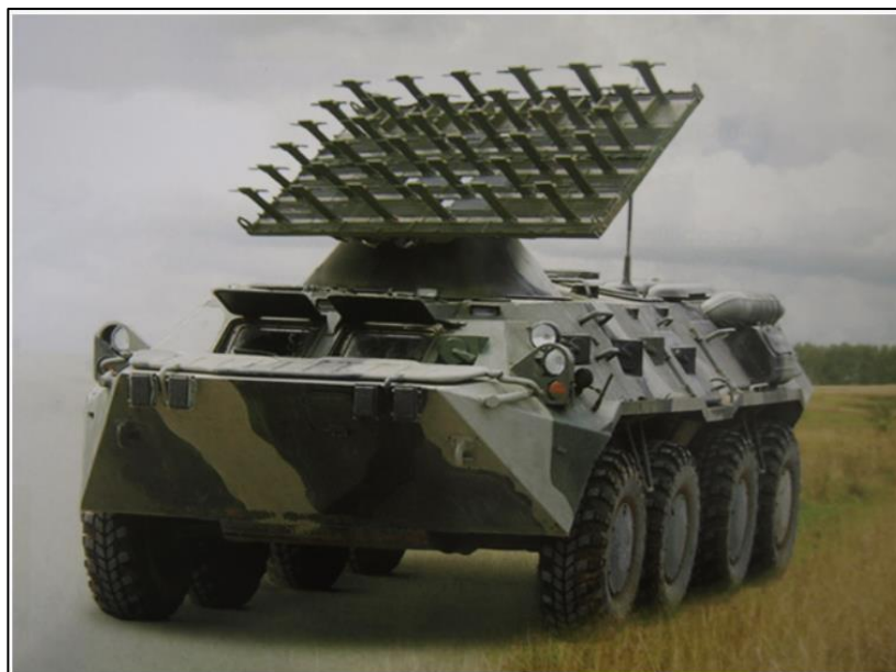
Figura 19: Radar 1L121 em uma Vtr sobre rodas 8x8 (BTR-80) Fonte: PAKISTAN DEFENCE, 2013
