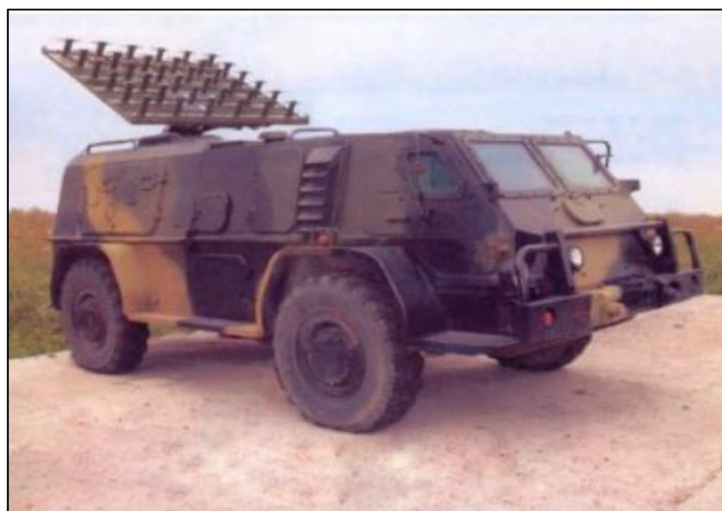
Figura 20: Radar 1L121 em uma Vtr sobre rodas 4x4 (GAZ-3937 Vodnik) Fonte: REDSTAR
