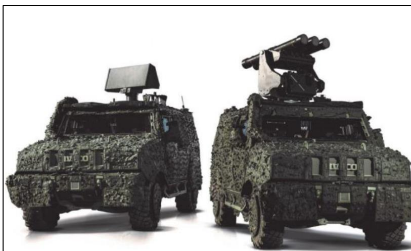
Figura 22: Giraffe 1x e Missil RBS 70 em plataformas mecanizadas Fonte: SAAB
