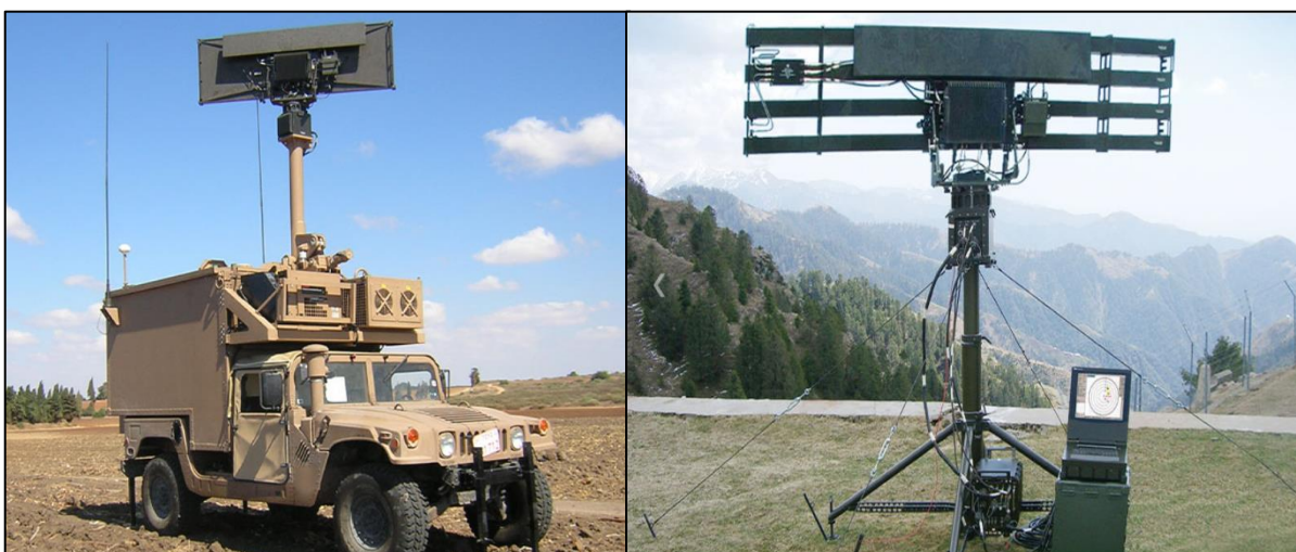
Figura 18: Radar ELM-2106 NG acoplado a uma Vtr e montado sobre um quadripé Fonte: O autor, adaptado de IAI ELTA SYSTEMS
