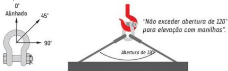
Figura 5 - Considerações relevantes ao utilizar a manilha
