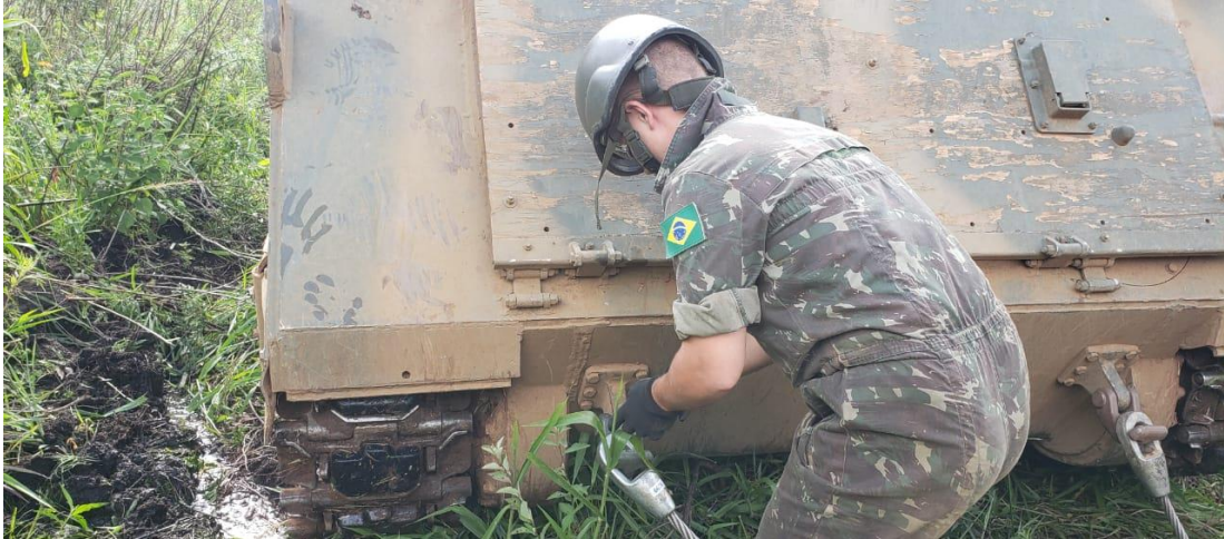
Figura 2 - Reboque de uma viatura M113BR atolada
