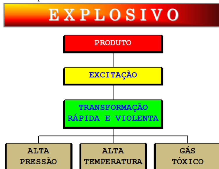
Figura 2- Funcionamento dos explosivos
