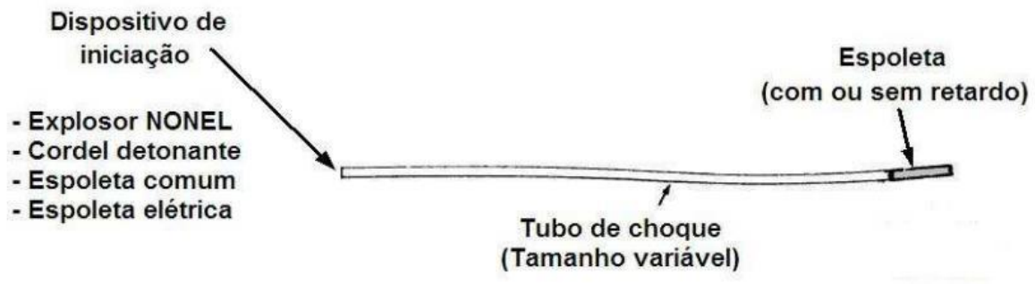
Figura 12- Dispositivo "NONEL" (Non-eletric)
