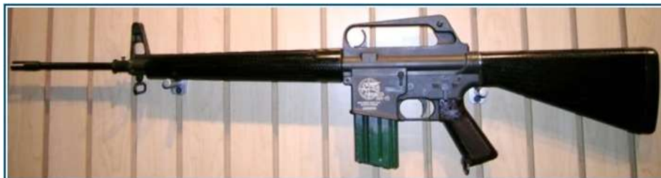
Figura 9 - Uma das primeiras versões do AR-15, ainda com a alavanca de ferrolho na parte superior, no vão interno da alça de transporte
