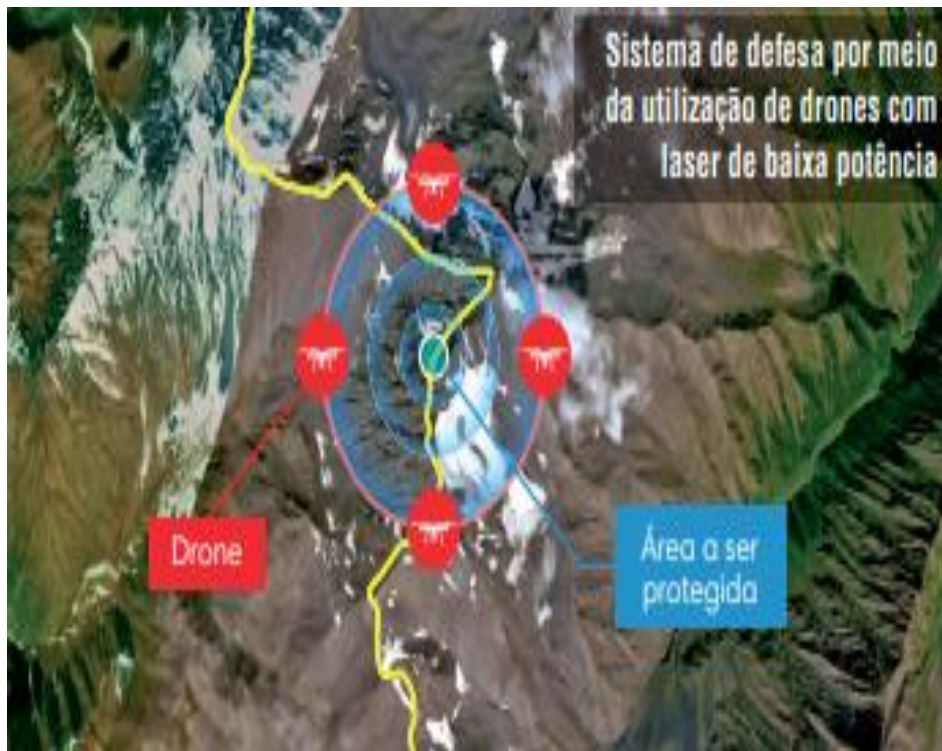
Figura 5 – Sistema de defesa por meio da utilização de drones com laser de baixa potência
