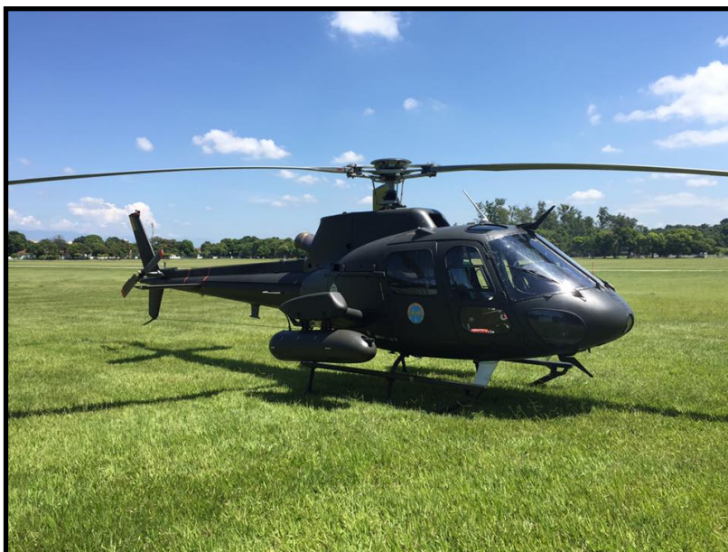
Figura 4: Fennec Av Ex configurado com Armamento Axial Fonte: PLAVETZ, 2016
