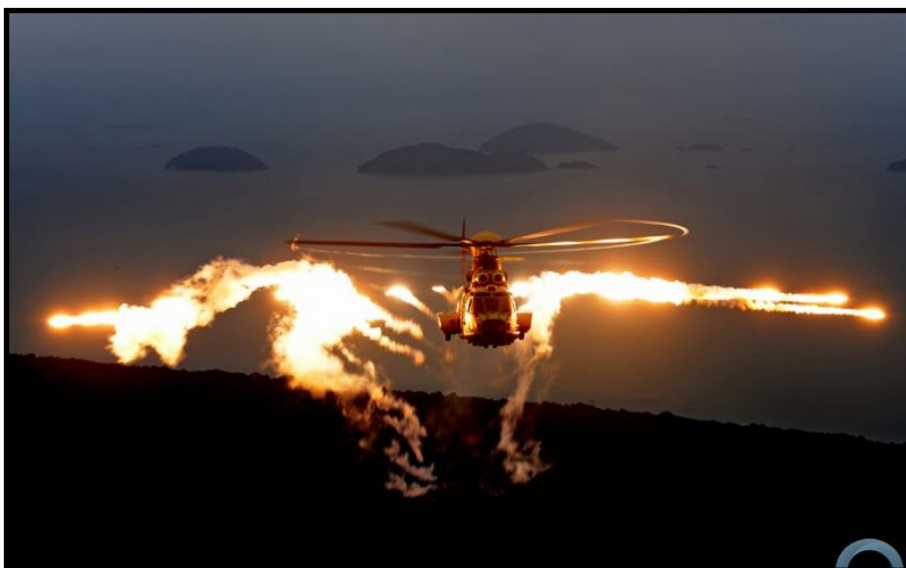
Figura 6: Sistema lançador de contramedidas “Chaff & Flare” da Aeronave Jaguar Foto: HELIBRAS / Anthony Pecchi Fonte: DEFESANET, 2013
