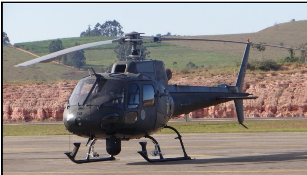
Figura 2: Fennec Av Ex configurado com o Sistema Olho da Águia Fonte: Acervo do 3º B Av Ex
