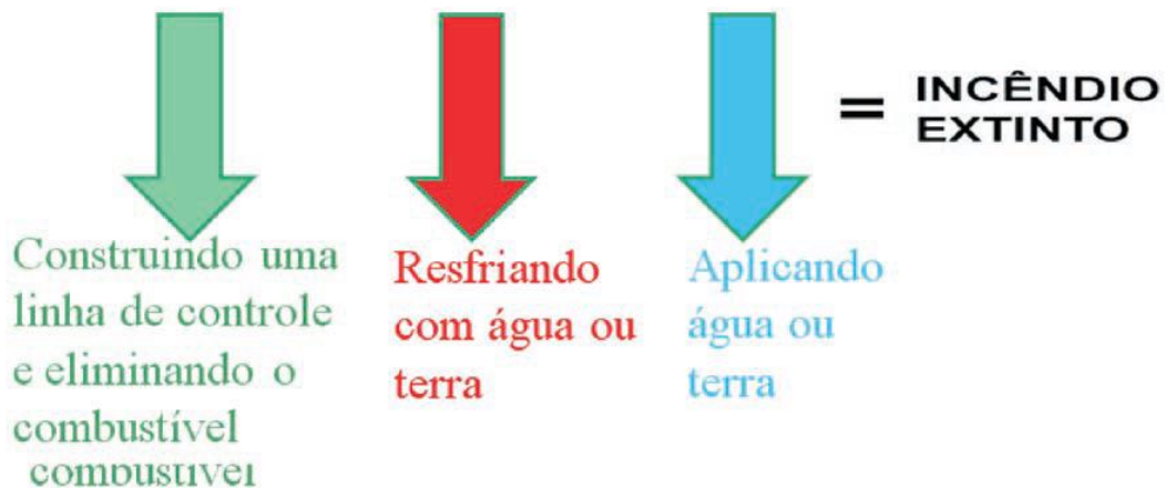
Figura 2 - Esquema ilustrativo do princípio básico utilizado no controle e extinção do fogo
