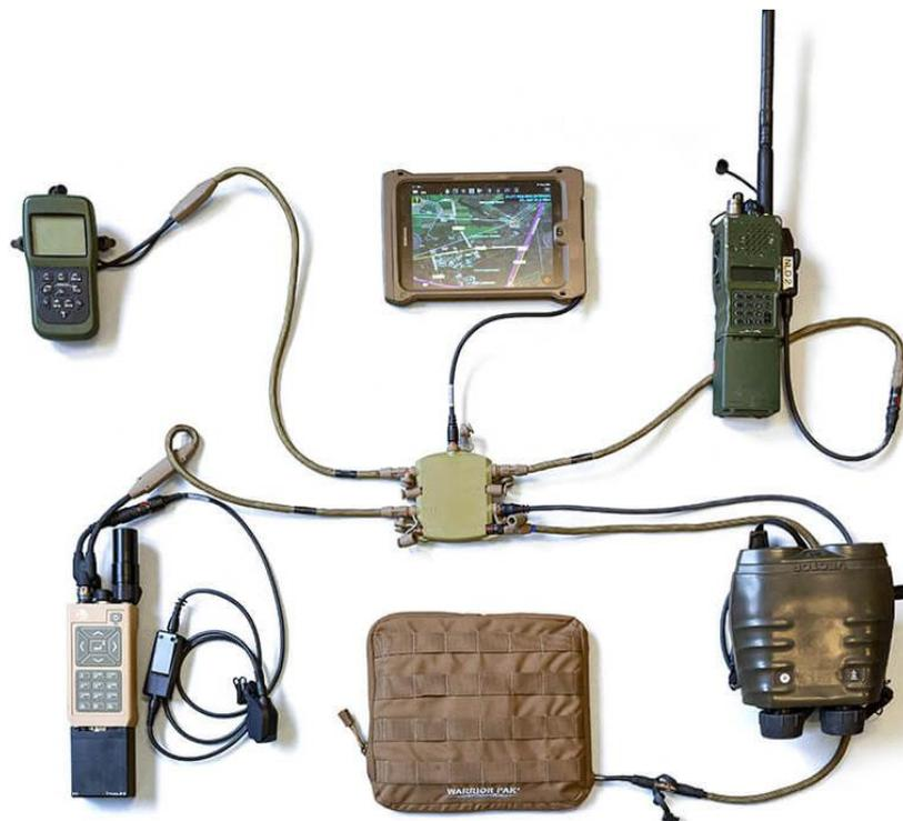
Figura 11 – Sistema integrado de condução de fogos aéreos DACAS – Digitally Aided Close Air Support<sup>8</sup>
