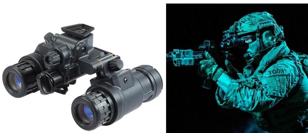
Figura 7 – Óculos de visão noturna de fósforo branco AN/PVS-31 e militar utilizando o OVN
