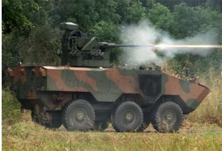
Figura 12: Tiro com o sistema de armas REMAX
